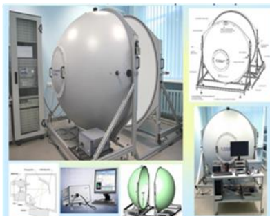
Проведення гоніофотометричних досліджень світлорозподілу
