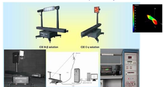
Проведення гоніофотометричних досліджень світлорозподілу
